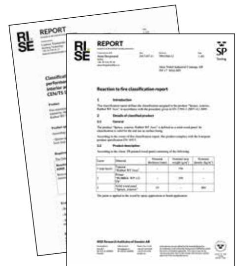
Es besitzt außerdem die Zulassung nach der Brandprüfung für Fassadenverkleidungen SP Fire 105. Im Rahmen dieser Zulassung wird die Feuerbeständigkeit von Untergründen aus nicht brandsicherer Fichte mit einer Mindestdicke von 19 mm bestimmt.
