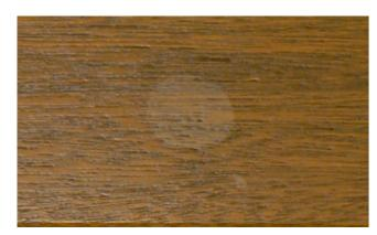
Holz behandelt mit herkömmlichem Produkt Ergebnis: Das Holz läuft weiß an, der Weißanlauf verschwindet nach einiger Zeit.
